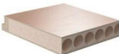
Röhrenspankern (RSPK) sind Türeinlagen, die aus einer vollflächigen Spanplatte mit ausgehöhlten Röhren bestehen. Die hochwertige Röhrenspankern-Einlage bietet eine hohe Stabilität und eine gute Geräuschdämmung (Flächengewicht ca. 15 kg/m<sup>2</sup>).
