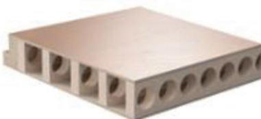
Röhrenspanstreifen (RSTR) sind Türeinlagen, die aus Streifen von Spanplatten bestehen. Sie erfüllen die Anforderungen aller Einsatzbereiche mit durchschnittlicher mechanischer Beanspruchung und sind damit deutlich stabiler als Türen mit Wabeneinlage (Flächengewicht ca. 12 kg/m<sup>2</sup>).
