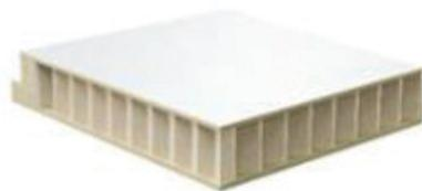
Als die wohl einfachste Konstruktion gilt in der Türenindustrie die Waben- oder auch Verbundeinlage (Flächengewicht ca. 8 kg/m<sup>2</sup>). Hier besteht das Innenleben aus einer Wabenstruktur aus imprägnierter Pappe. Entgegen der landläufigen Meinung ist diese Konstruktion - technisch betrachtet - besser als ihr Ruf.
